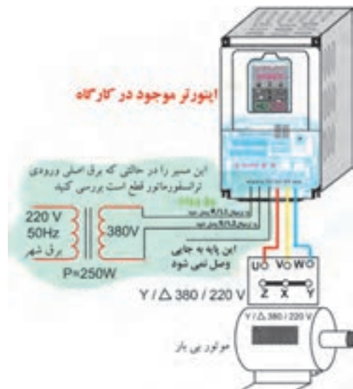
شکل ۱۵- راه‌اندازی اینورتر با برق ورودی سه فاز ۳۸۰ ولت به کمک ترانسفورماتور ۲۲۰/۳۸۰ V یکفاز
