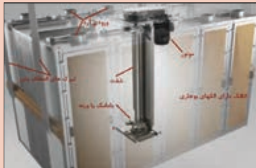
شکل ۳۴- موتور ۷۵ کیلووات با جریان نامی ۱۷۰ آمپر
