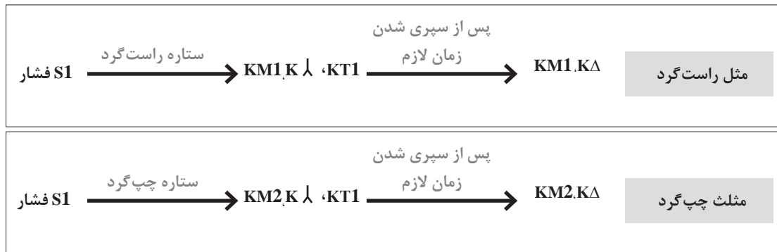
شکل ۲۶- نحوه عملکرد قطعات در مدار فرمان
