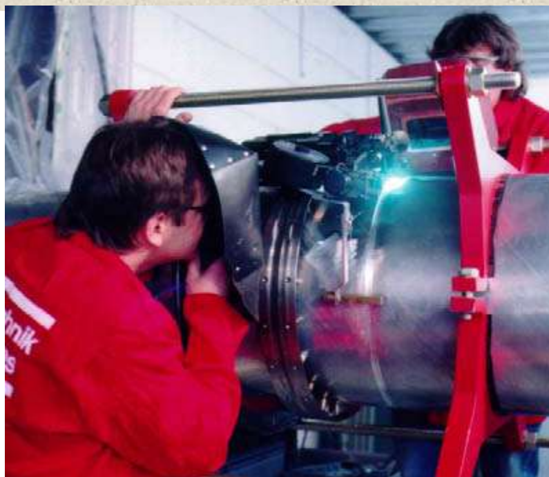
شکل (۵-۱۰) کنترل جوشکاری توسط یک آنالیزور کامپیوتری
