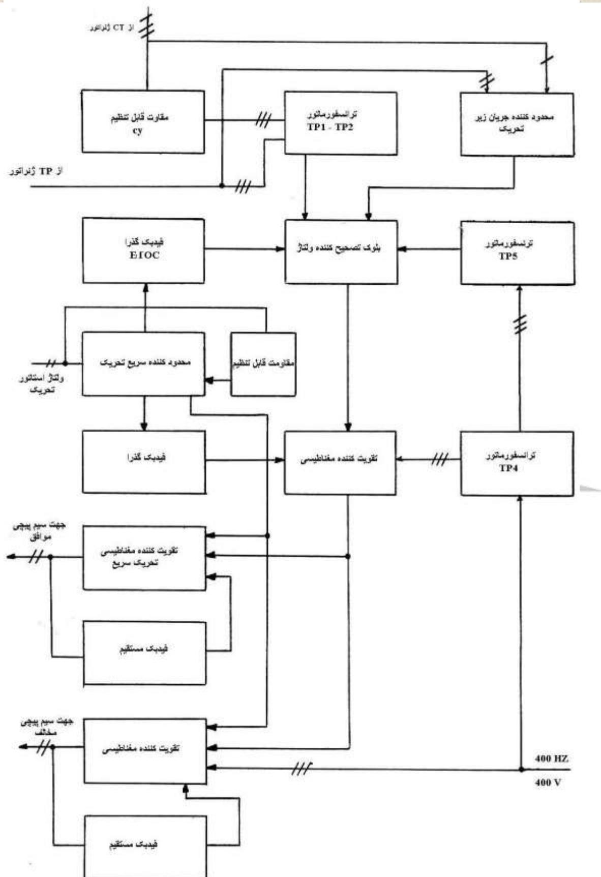
شکل ۱-۴ : پانل EP-500 و المانهای درون آن
