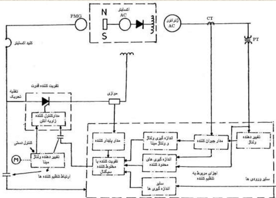
شکل ۱۵-۲: سیستم کنترل میدان تحریک با استفاده از اکسایتر آلترناتوری و یکسو کننده که در آن یکسو کننده از نوع گردان می باشد.
