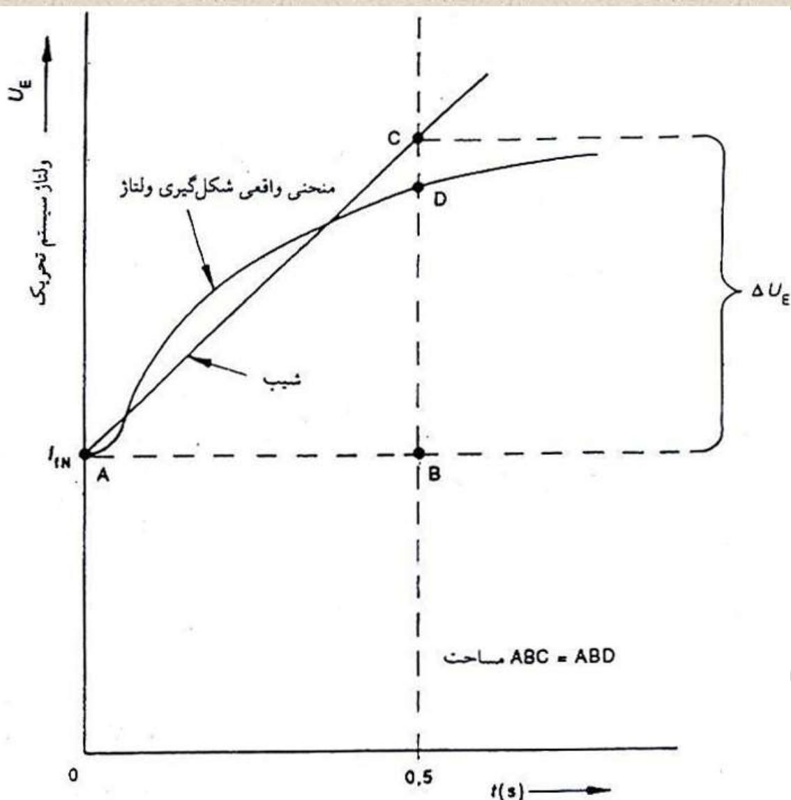
شکل ۲-۲: تعیین پاسخ نامی سیستم تحریک
