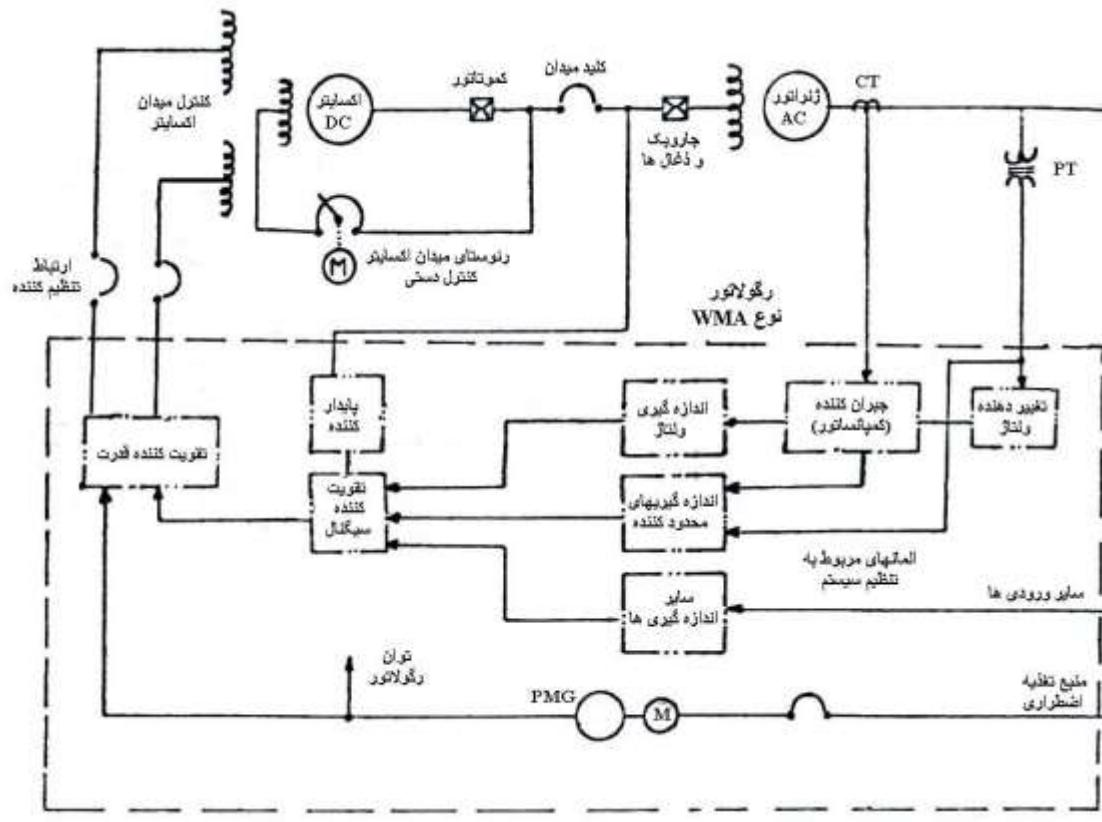
شکل ۱۳-۲: کنترل میدان تحریک به وسیله اکسایتر با ژنراتور DC کمترور دار
