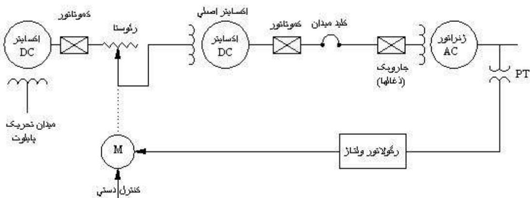
شکل ۱۱-۲: اکسایتر اصلی با سیستم تحریک از طریق پایلوت<sup>۱</sup>
