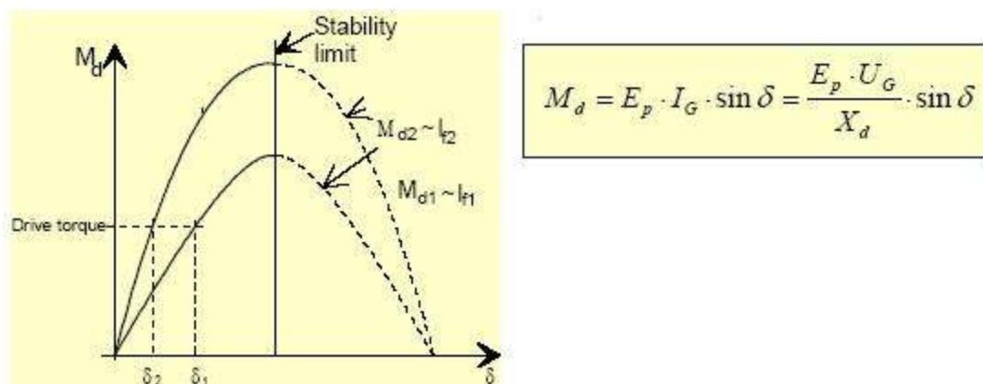
شکل ۱۱-۱ : مشخصات گشتاور ژنراتور
