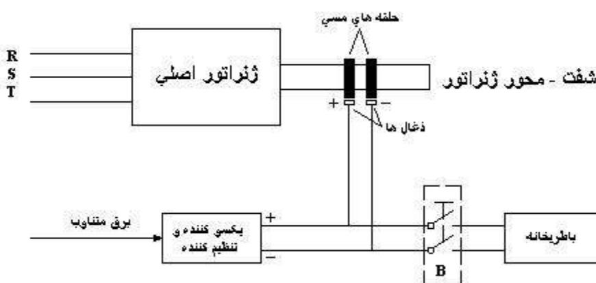
شکل ۳-۲ : سیستم تحریک استاتیکی
