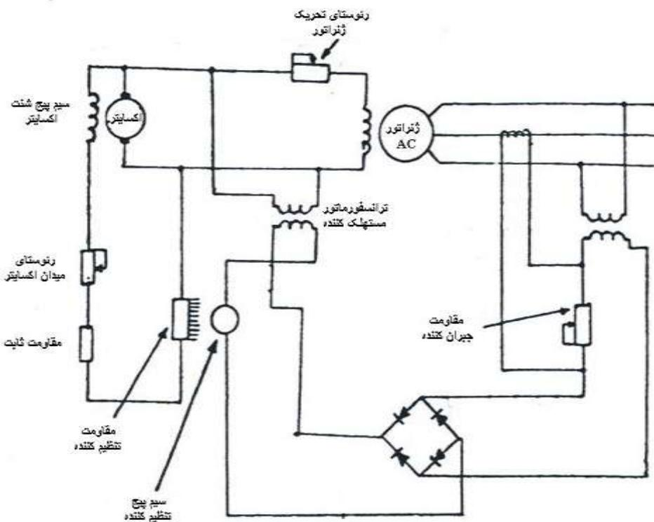
شکل ۱۰-۲: اکسایتر با تحریک سرخود و رگولاتور سیلوراستات
