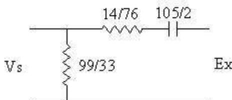
شکل ۵-۳: مدار معادل پایدار ساز سیستم تحریک
