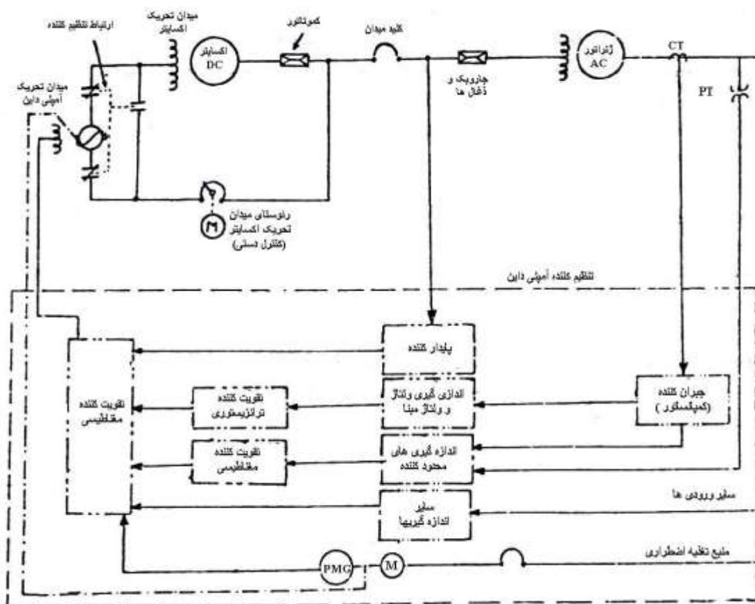
شکل ۱۲-۲ : سیستم کنترل میدان تحریک با ژنراتور DC کمotaتور دار
