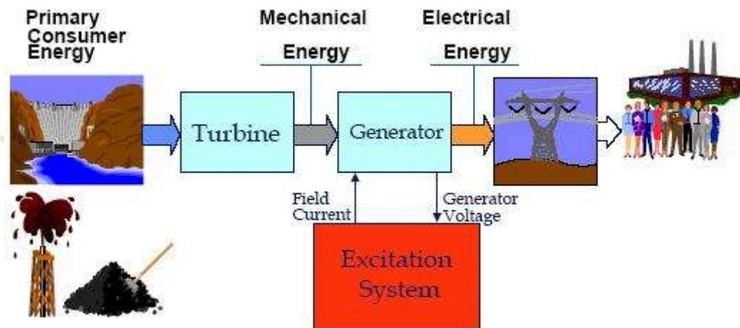
شکل ۲-۱ : جایگاه سیستم تحریک در تولید انرژی الکتریکی
