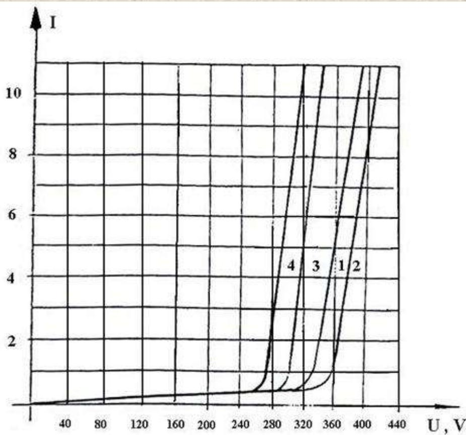
شکل ۱۰-۴ : منحنی ولتاژ و جریان محدود کننده سریع تحریک
