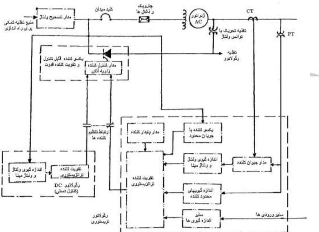
شکل ۱۸-۲: سیستم کنترل میدان تحریک با استفاده از اکسایتر و یکسو کننده تغذیه ولتاژی
