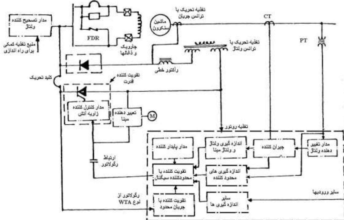
شکل ۱۷-۲ : سیستم کنترل میدان تحریک با استفاده از ترکیبی از اکسایتر با یکسو کننده مرکب با یکسو کننده که منبع تغذیه آن ولتاژی باشد.
