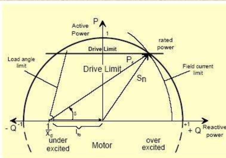
شکل ۱۲-۱ : دیاگرام توان ماشین سنکرون
