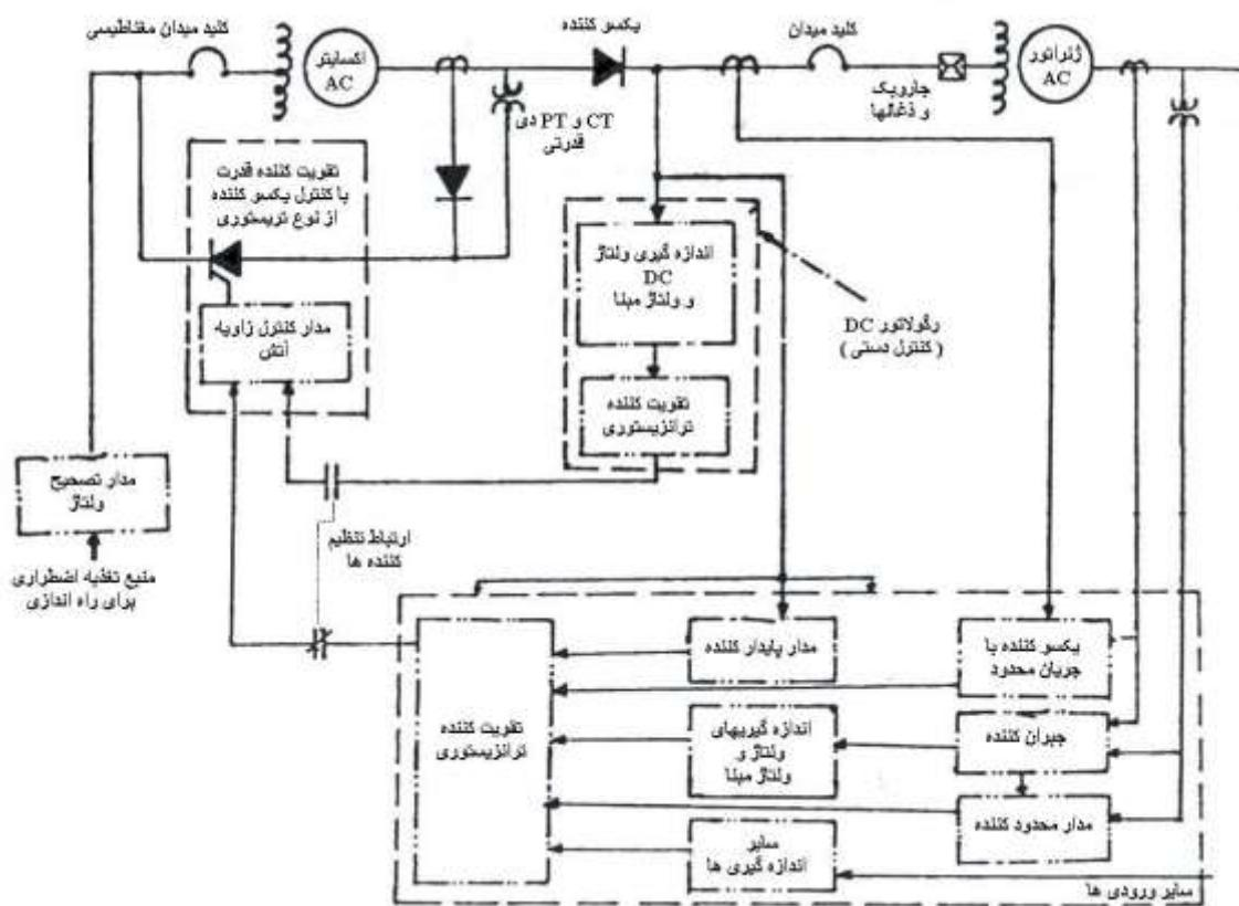
شکل ۱۴-۲: سیستم کنترل میدان تحریک به وسیله اکسایتر با یکسو کننده آلترناتوری و استفاده از یکسو کننده های دیودی
