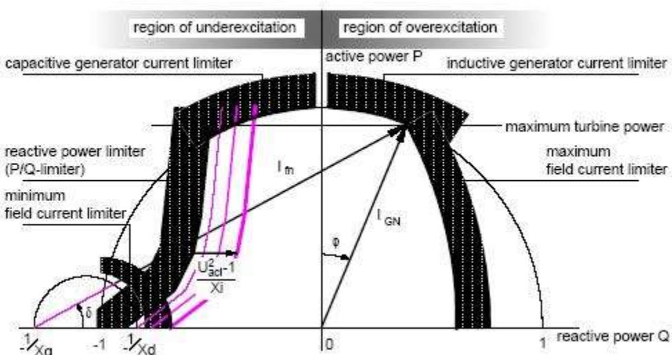
شکل ۱۳-۱ : دیاگرام توان ماشین سنکرون
