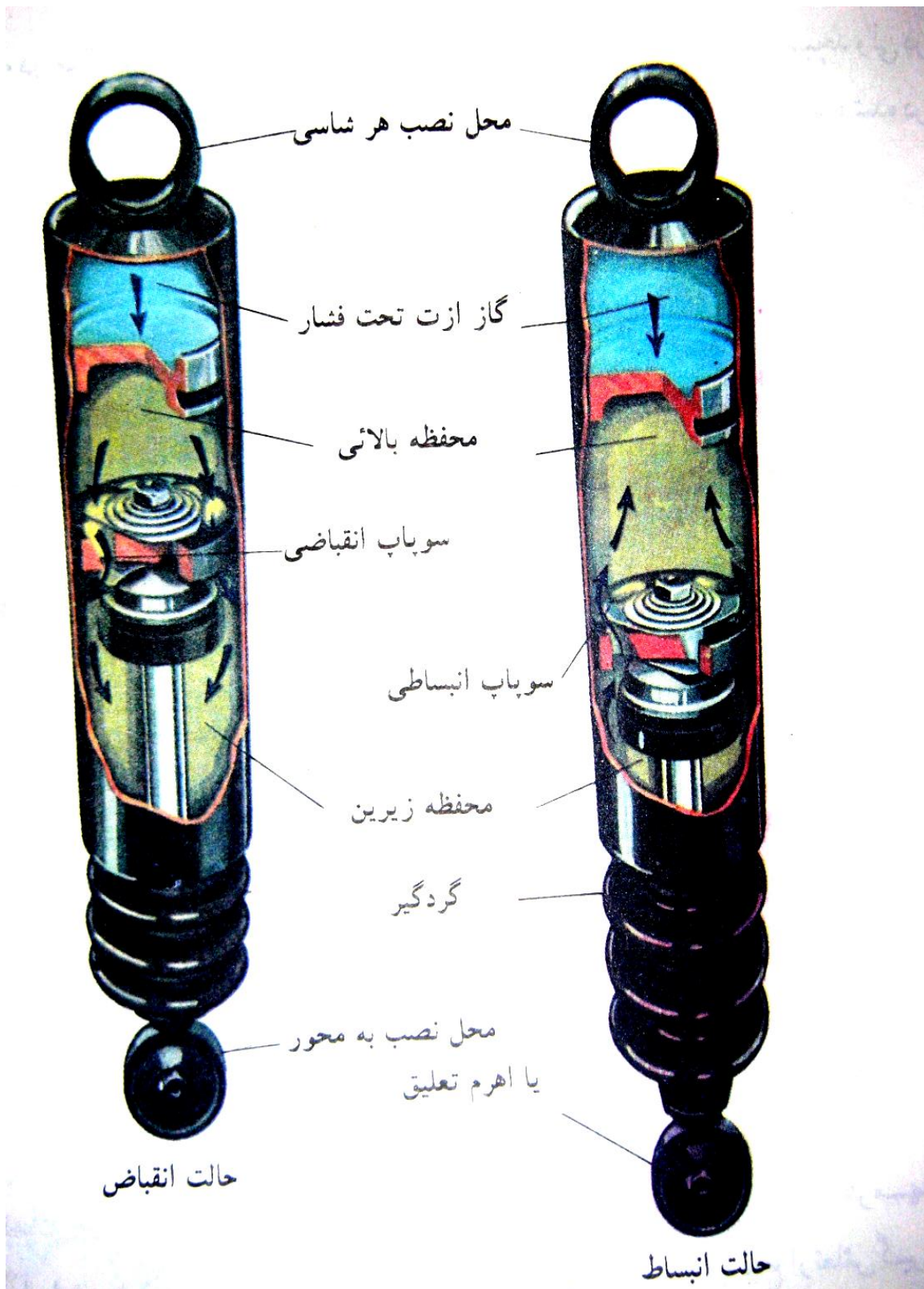
شکل ۳۶- اجزا و قطعات کمک فنر تلسکوپی
