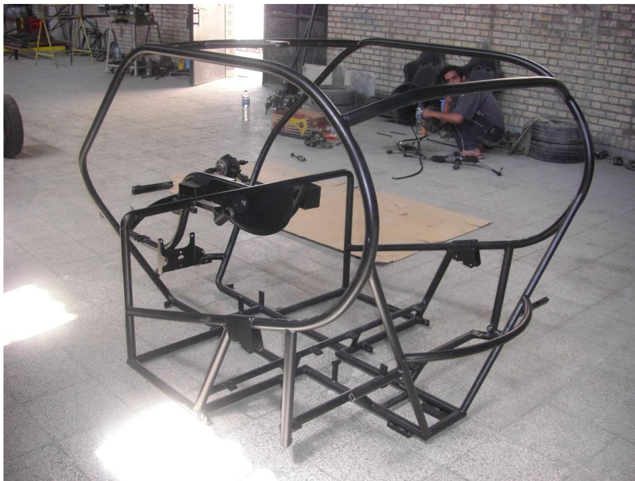
شکل ۱۱- شاسی یکپارچه یک ماشین باگی. مونتاژ در ایران
