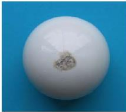
شکل ۱۰-۵ ریشه جرقه بعد از ۵۰ شکست روی یک الکتروود با ضخامت پوشش 300 \mu\text{m}
