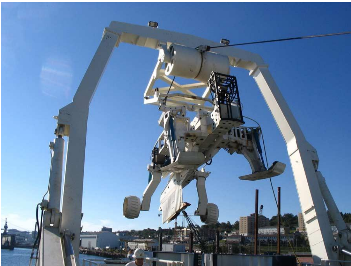
شکل ۳-۵: ربات هایی مخصوص برای خوابانیدن کابل در بستر دریا
