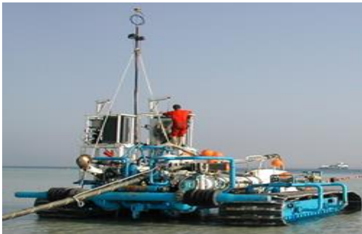
شکل ۲-۵: ربات هایی مخصوص برای خوابانیدن کابل در بستر دریا
