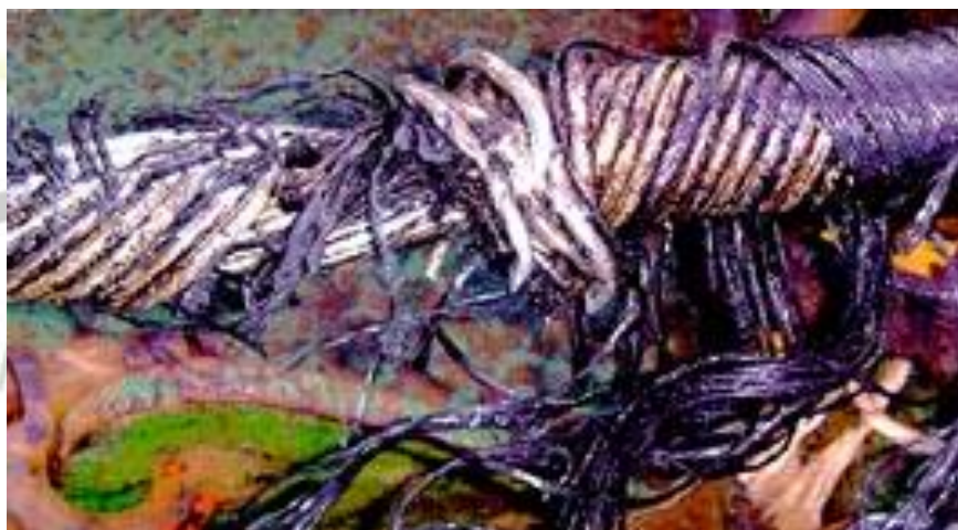
شکل ۲-۳: پاره شدن کابل های زیر دریایی در اثر برخورد با لنگر کشتی
