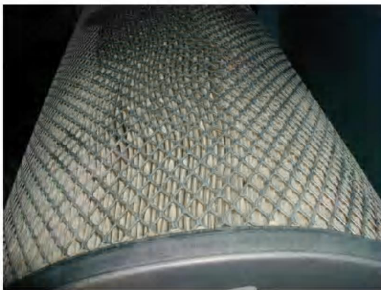
شکل ۲۰: چگونگی نفوذ آب درون فیلترهای هوایی. انحراف شیارهای فیلتر فشنگی
