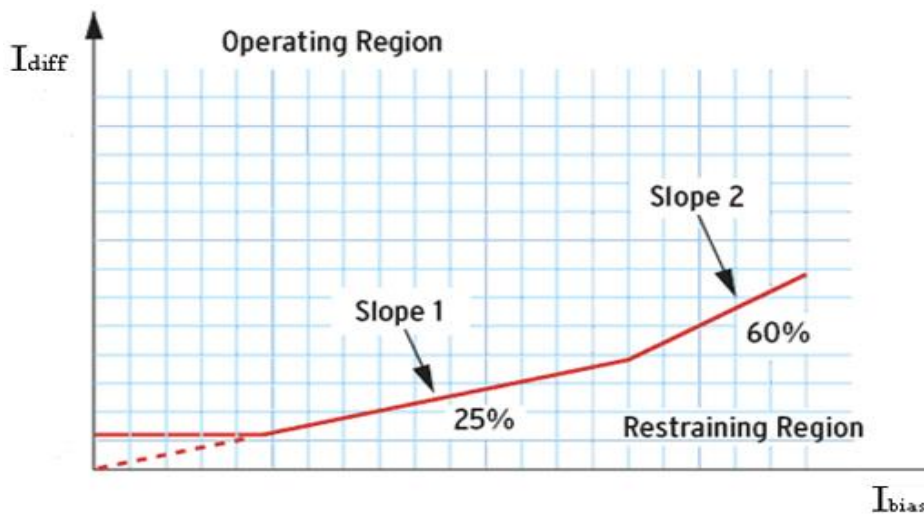
شکل ۴-۱۷ مشخصه تفاضلی گرایشی رله دیفرانسیل دیجیتال
