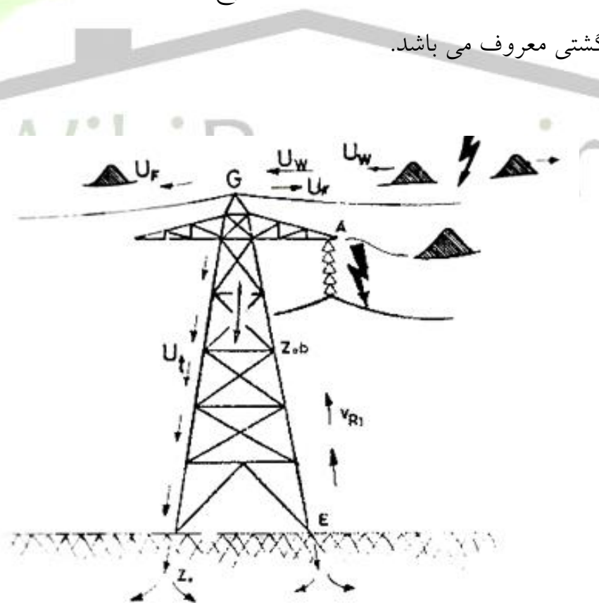
شکل (۷-۵): نمایش موجهای منتشر و منعکس شده در اثر برخورد صاعقه به سیم زمین
