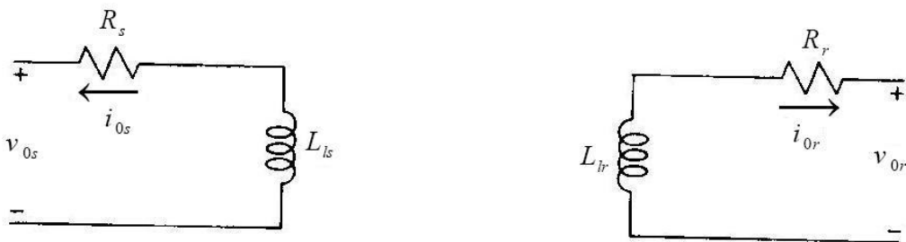
شکل ۲-۳: مدل ماشین القایی با جهت ژنراتوری در قاب سنکرون
