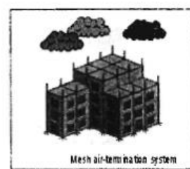
برقگیر با اتصالات مش یا فاراده
