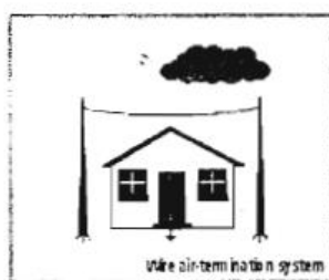
برقگیر با اتصالات سیمی
