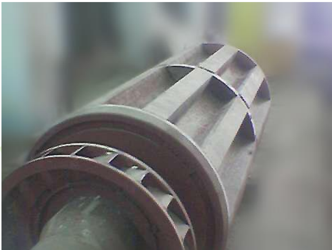
شکل فوق نمایی از روتور ماشین تحریک اصلی را نشان می دهد.
