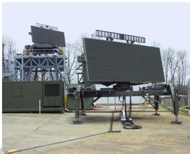
رادار ارایه فازی برای ایستگاه های زمینی هواشناسی
