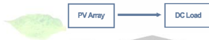
شکل ۱-۳ دیاگرام سیستم فتوولتائیک مستقل از شبکه سراسری
