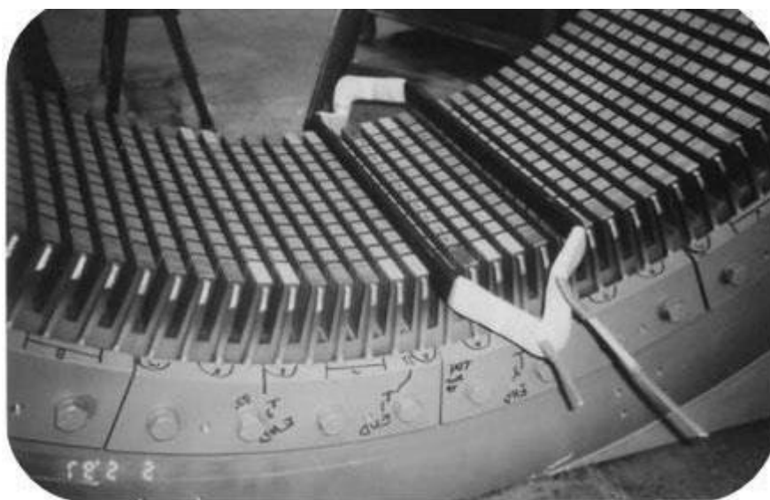
شکل ۱-۲: جانماییک کلافتک حلقه‌ها در داخل دوشیاری استاتور یک ماشین الکتریکی فشار قوی
