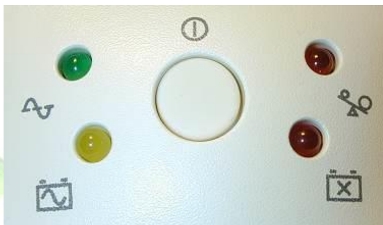
تک کلیدی UPS
