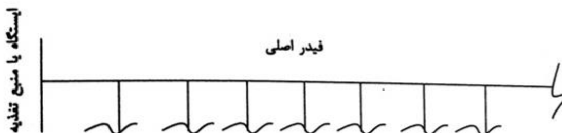
شکل ( ۱- ۲ ) : نمونه یک فیدر با توزیع یکنواخت بار [ ۴ ]
