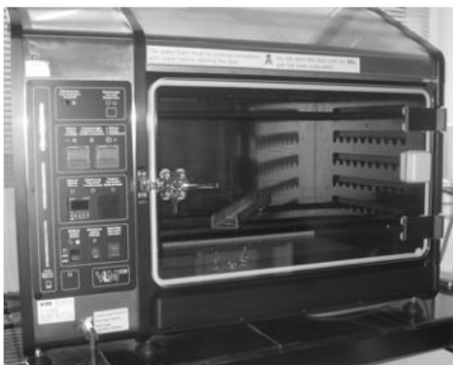
شکل ۱- محفظه آزمون خوردگی دی اکسید گوگرد در اتمسفر مرطوب اشباع مطابق استاندارد ASTM
