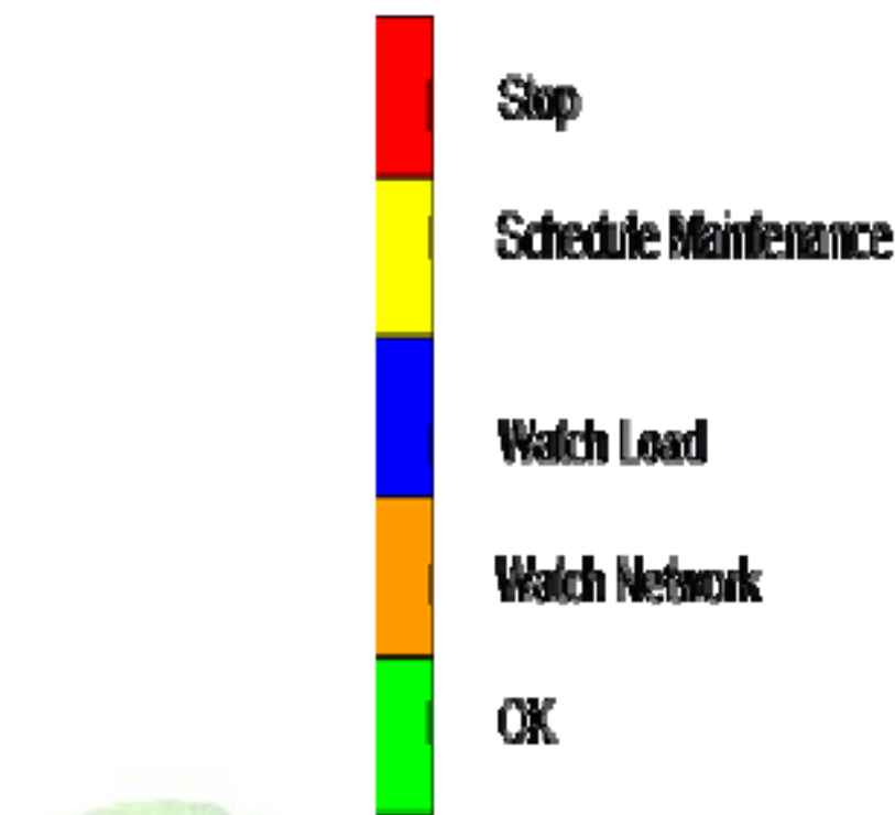
شکل (۴-۵) نمایی از علائم هشدار دهنده دستگاه MCM
