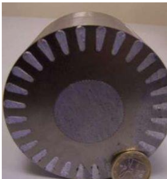
شکل (۱-۲) تصویری از روتور یک موتور، روتور قفسی
