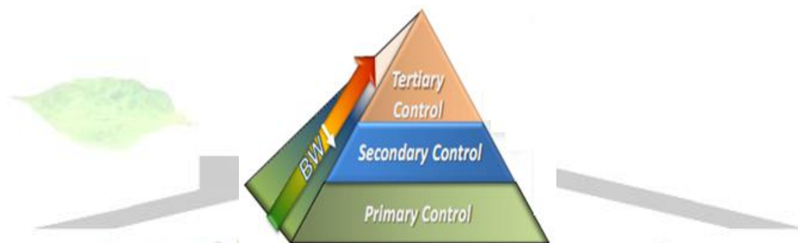
شکل ۲۱ ساختار کنترل سلسله مراتبی
