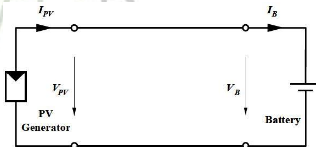
شکل ۵۸-۳ اتصال مستقیم pv به باتری
