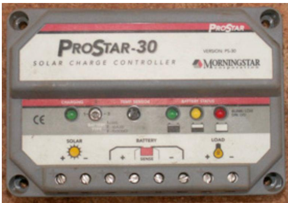
شکل ۳-۵۳ یک نمونه‌ی واقعی از دستگاه کنترل شارژ باتری‌ها
