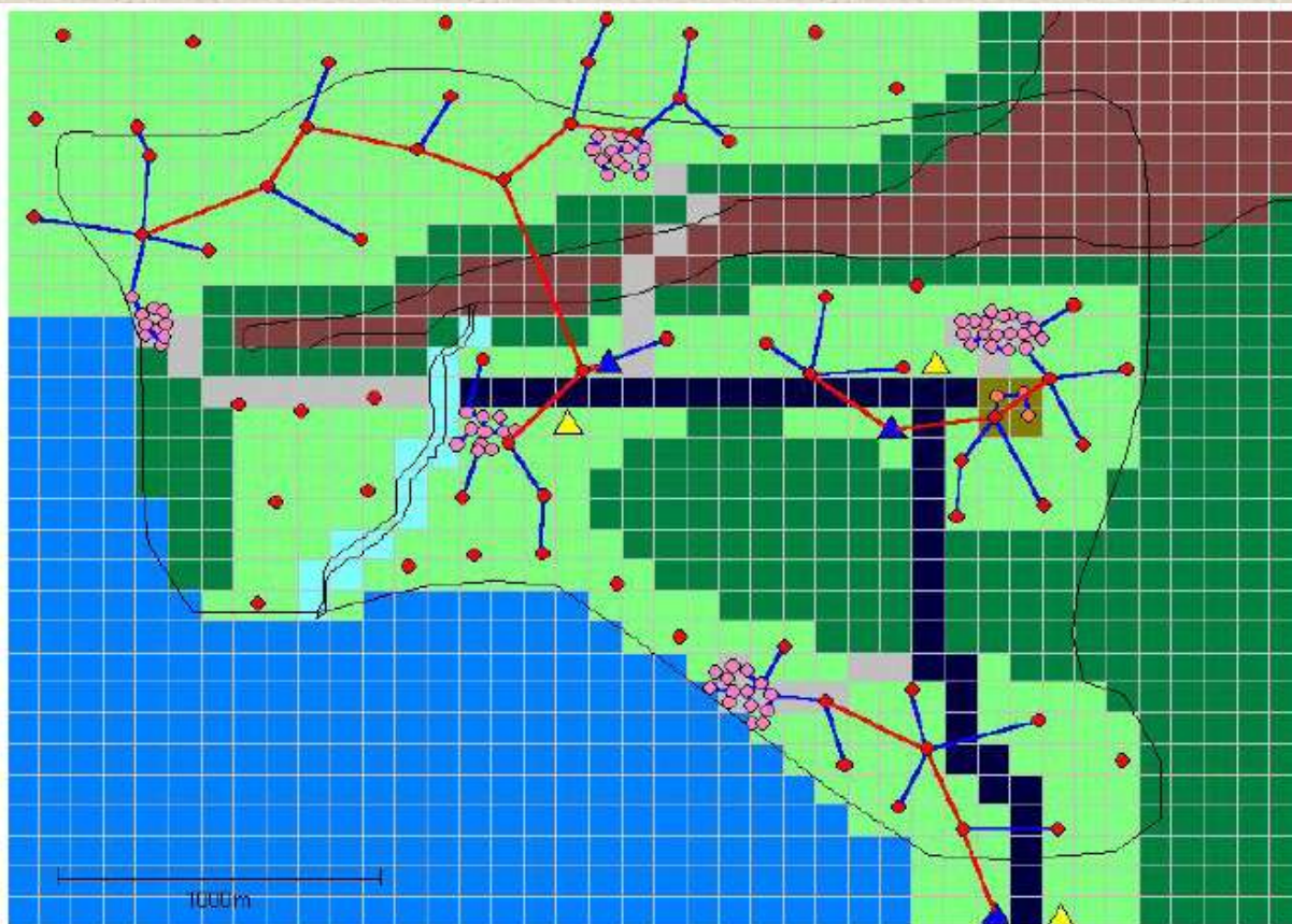
شکل ۱۱- تصویر شماتیک شبکه توزیع دارای بهترین ویژگیهای اقتصادی
