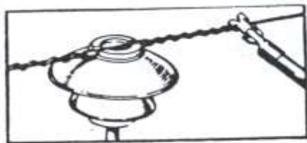
شکل (۲-۳) آزاد کردن انتهای سیم اصلی به کمک تیغه ثابت
