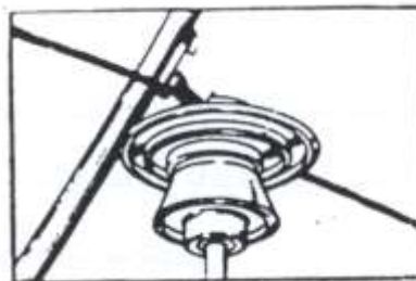
شکل (۱-۳) آزاد کردن انتهای سیم اصلی به کمک قسمت C شکل استیک عمومی
