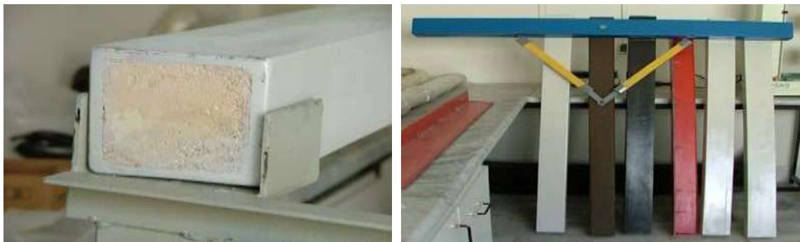
شکل ۳-۲ - هفت نمونه کراس آرم کامپوزیتی ساخته شده و مقطع کراس آرم های قوطی شکل
