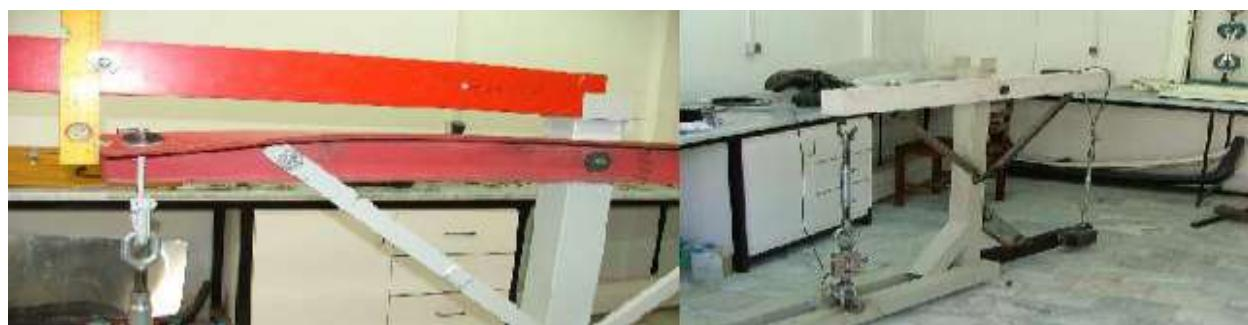
شکل ۱-۳- نحوه انجام تست خمش نامتقارن بر روی کراس آرم قوطی شکل و نبشی
