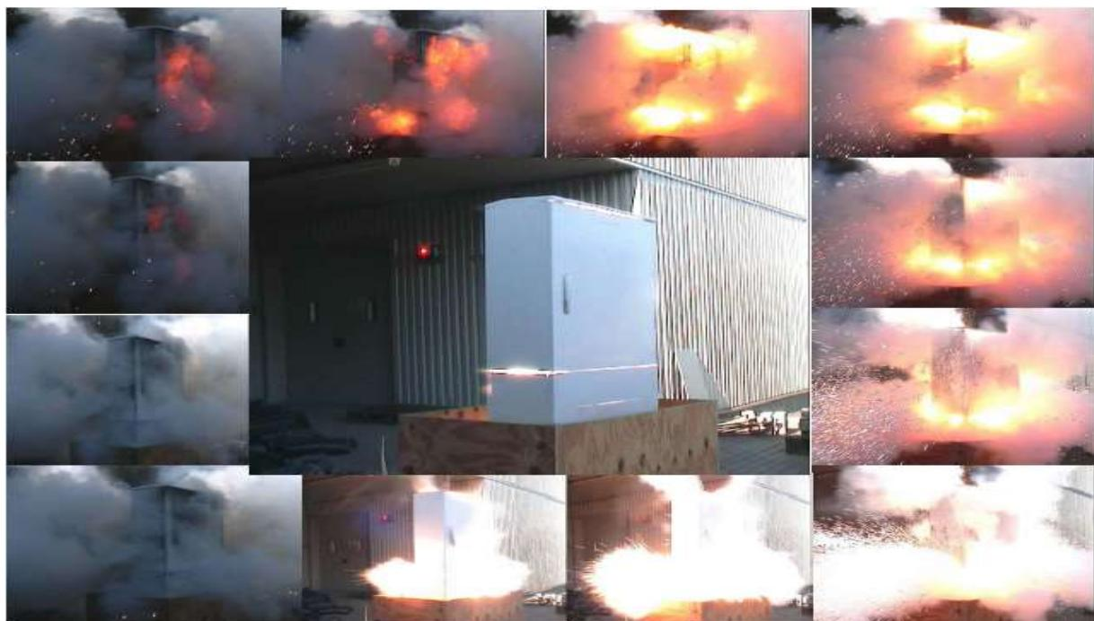
شکل ۱-۴- مقاومت تابلوهای کامپوزیتی در برابر آتش
