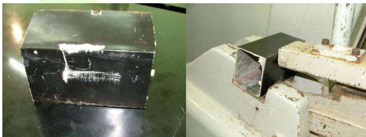
شکل ۳-۵- نمونه کامپوزیتی در حین و پس از تست ضربه با پتک سنگین
