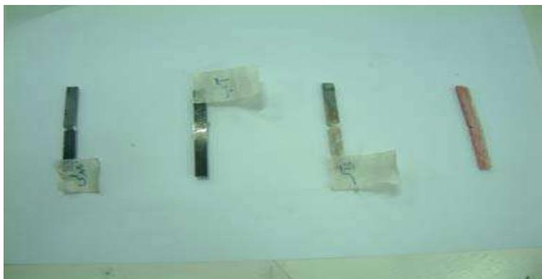
[شکل ۳-۸- نمونه های شارپی در شرایط محیطی متفاوت]
