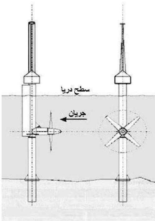
توربین های جزر و مدی استفاده شده در جریانات جزر و مدی چرخشی با سرعت بین ۲ تا ۳ متر بر ثانیه دارند که تولیدی بین ۴ تا ۱۳ کیلووات بر مترمربع دارند. در چرخش های سریعتر (بیشتر از ۳ متر بر ثانیه) باعث بوجود آمدن فشار و تنش های بی مورد بر روی تیغه های توربین می شود، همانند توربوژنراتورهای بادی که در اثر نیروهای باد و طوفانهای شدید آسیب می بینند. البته باید دانست که سرعت پائین هم خیلی اقتصادی نمی باشند.
