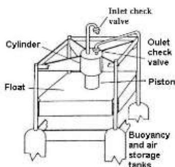
شکل ۱-۳- طرح یک ماشین شناور موج- نیرو
