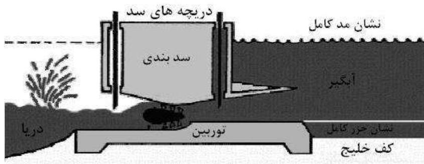
شکل ۲- روش تولید در جزر با توربین حبابی
