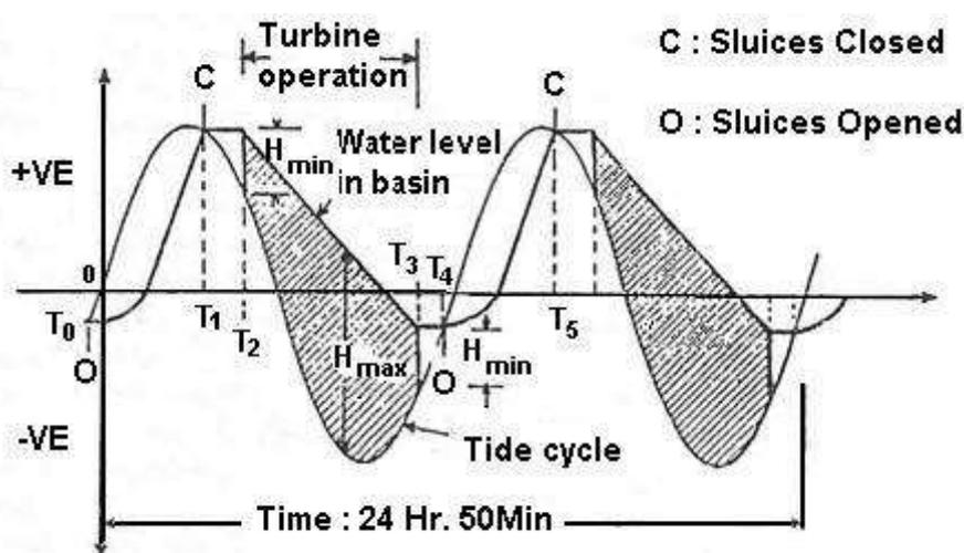
شکل ۲-۴- سیکل کارکرد سیستم یک حوضچه ای با جریان از سوی حوضچه به دریا
